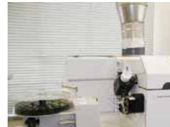
組成分析のための ICP 質量分析装置
