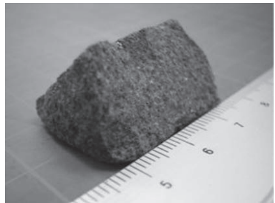
Fig.2 セラミック多孔質体(例) (石炭灰:ガラス=5:1)
