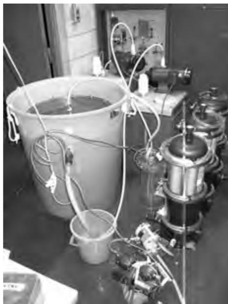
図 2. 水中腐植物質濃縮システム外観
