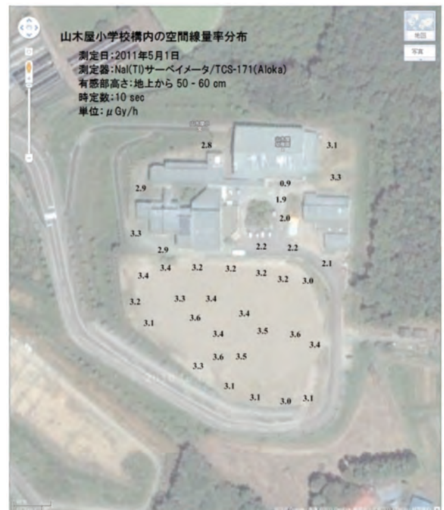
図 3 歩行サーベイシステムによって測定した山木屋小学校校内の空間線量率分布
