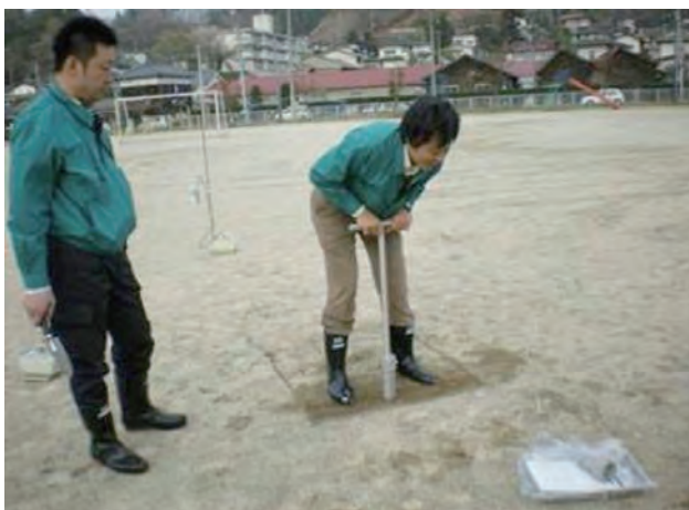
図4 土壌採取器による採取の様子
