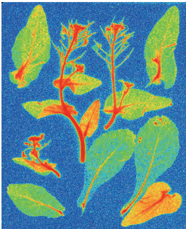
図7 イメージングプレートによって得られた菜の花の放射能分布画像（5月1日に採取したもの）
