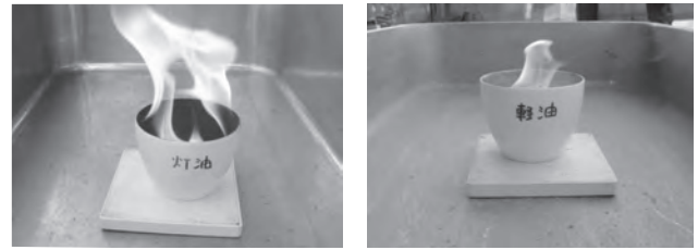
図3 燃焼実験の状況
