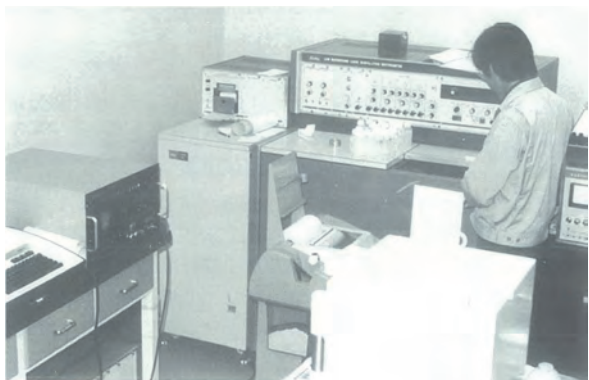
写真2 環境放射能分析室完成当時導入した低バックグラウンド液体シンチレーションカウンター (環境管理第10号より)
