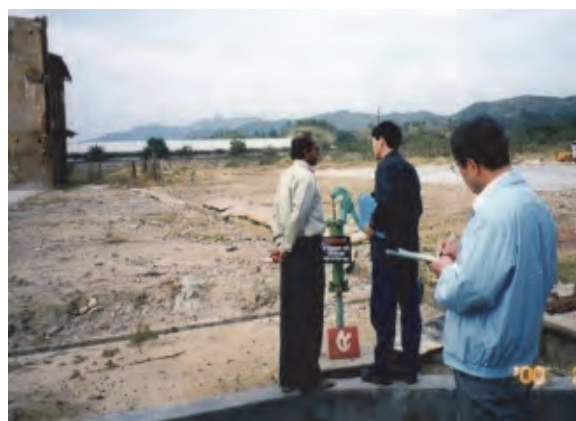
写真3 工場跡地に設置されたモニタリング井戸
