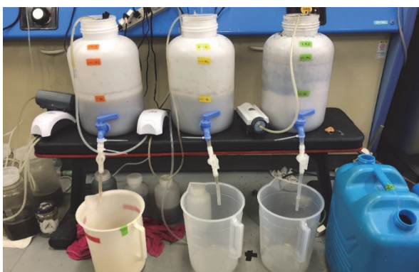
写真3 回分活性汚泥法の実験の状況(左からブランク系,石けん系,LAS系)
