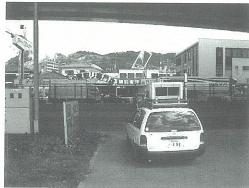
写真3 道路沿線に対して直角に停車時の自然風によるNO<sub>x</sub>浄化試験
